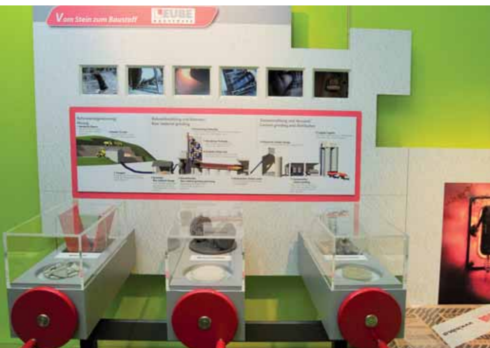
Aus Gestein wird Zement. Im Science Center veranschaulicht LEUBE mit Hilfe von Funktionsmodellen, einem Flow Sheet (Schaubild) und kurzen Videos, wie aus Gestein Zement hergestellt wird.
